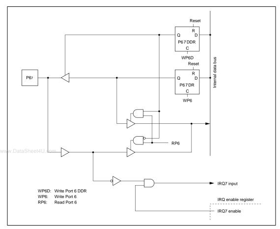
Figure 6.6 (d) Port 6 Schematic Diagram (Pin P6<sub>7</sub>)
