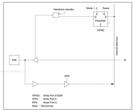
Figure 6.9 (d) Port 9 Schematic Diagram (Pin P9<sub>6</sub>)
