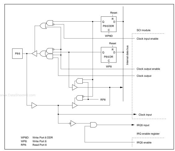
Figure 6.8 (d) Port 8 Schematic Diagram (Pin P8<sub>6</sub>)
